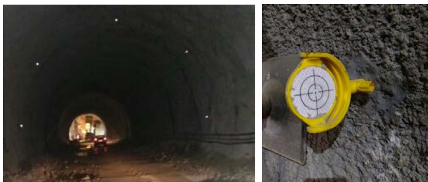
Слика 10. Рефлектори (призме) за мјерење радијалних помјерања у тунелу Мрке
