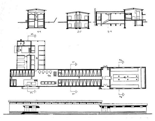
Figure 4. Project of a winery in the village of Rajac with a capacity of 150 wagons ("Invest zavod"Belgrade) (Б. Којић, Ђ. Симоновић, Пољопривредне зграде и комплекси, Београд: Грађевинска књига, 1978. р.163.)
